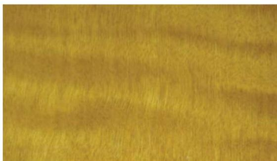
Figura 8. Cerne de grumixava (*Micropholis gardnerianum*), árvore da família Sapotaceae, que apresenta grã irregular, indicada pelas ondulações na peça de madeira – a grumixava é a madeira alternativa para uso em fundos de instrumentos de arco, em substituição ao plátano (*Acer pseudoplatanus* ou *Acer platanoides*), madeira de região temperada usada para tal finalidade
