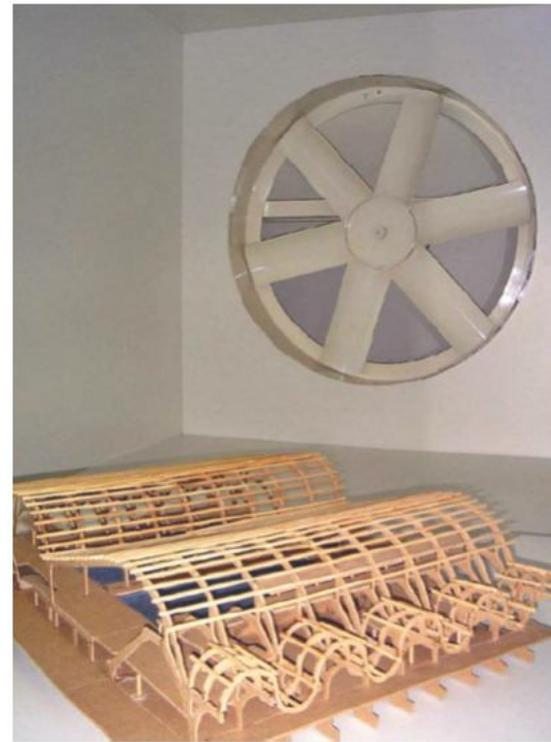
Túnel de vento montado no Laboratório de Eficiência Energética e Conforto Ambiental, da Unisul
