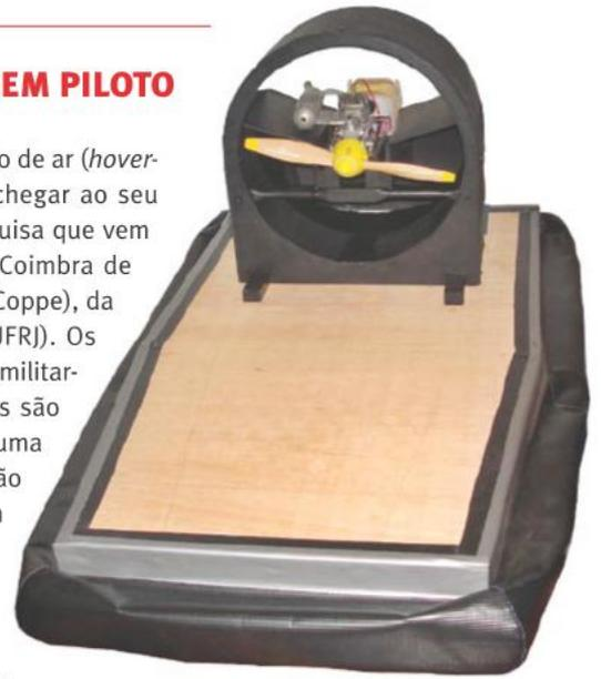
**Protótipo do hovercraft desenvolvido na UFRJ que, além de se locomover sobre um colchão de ar, não requer piloto**
