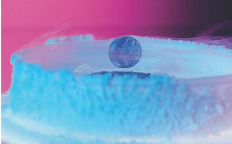
Ímã (centro da imagem) levitando sobre um supercondutor de alta temperatura crítica, resfriado com a ajuda de nitrogênio líquido. O fenômeno de levitação, no caso, deve-se ao chamado efeito Meissner
