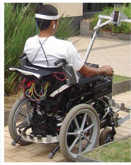
Movida pela 'imaginação motora', a cadeira tem acoplado um sistema que capta as ondas geradas pela intenção do movimento das mãos de pessoas com deficiência
