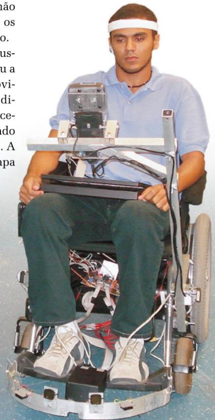
motora. Nesse sistema, são as ondas geradas pela intenção do movimento das mãos que move a cadeira: se a pessoa quer ir para a direita, pensa em abrir e fechar a mão direita; se quer ir para a esquerda, faz o mesmo com a mão esquerda; se quer ir para frente, pensa nos dois movimentos seguidos e se quer parar basta não pensar em nenhuma das opções.
