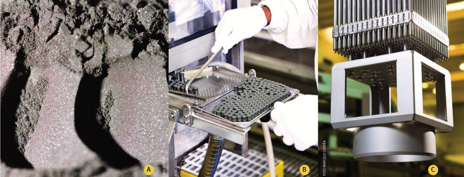
Após o enriquecimento do urânio, o gás hexafluoreto é reconvertido no pó de dióxido de urânio (A), utilizado para criar as pastilhas (B) que energizam o reator da usina nuclear. Elas são inseridas nos elementos combustíveis (C), recipientes feitos com uma liga de aço especial chamada zircaloy
