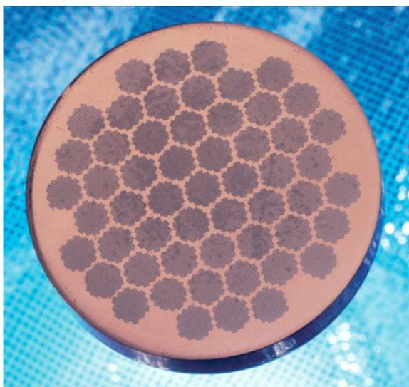
Figura 1. A imagem mostra – em um corte transversal – os fios de material supercondutor usados no Grande Colisor de Hádrons (LHC), envolvidos em uma matriz de cobre. Quando resfriados até a temperatura crítica, na presença de um campo magnético, os 8 mil filamentos de nióbio-titânio desses fios apresentam resistência nula e conduzem elevada corrente elétrica sem perda de energia
