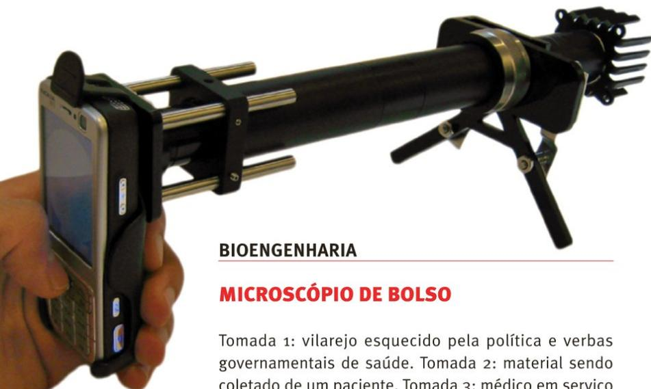
**CellScope,** que transforma um celular em microscópio
