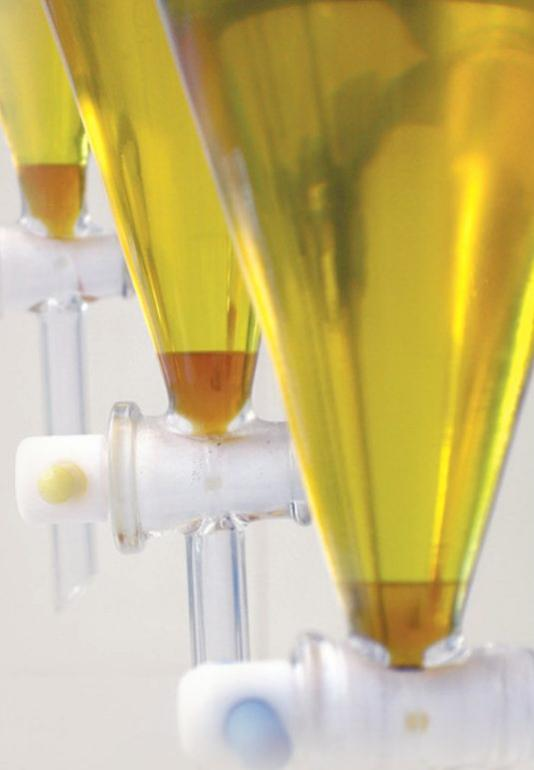
Figura 2. Separação de fases no biodiesel produzido por catálise homogênea. Nesse processo, o catalisador não se separa das fases, ficando misturado nelas
