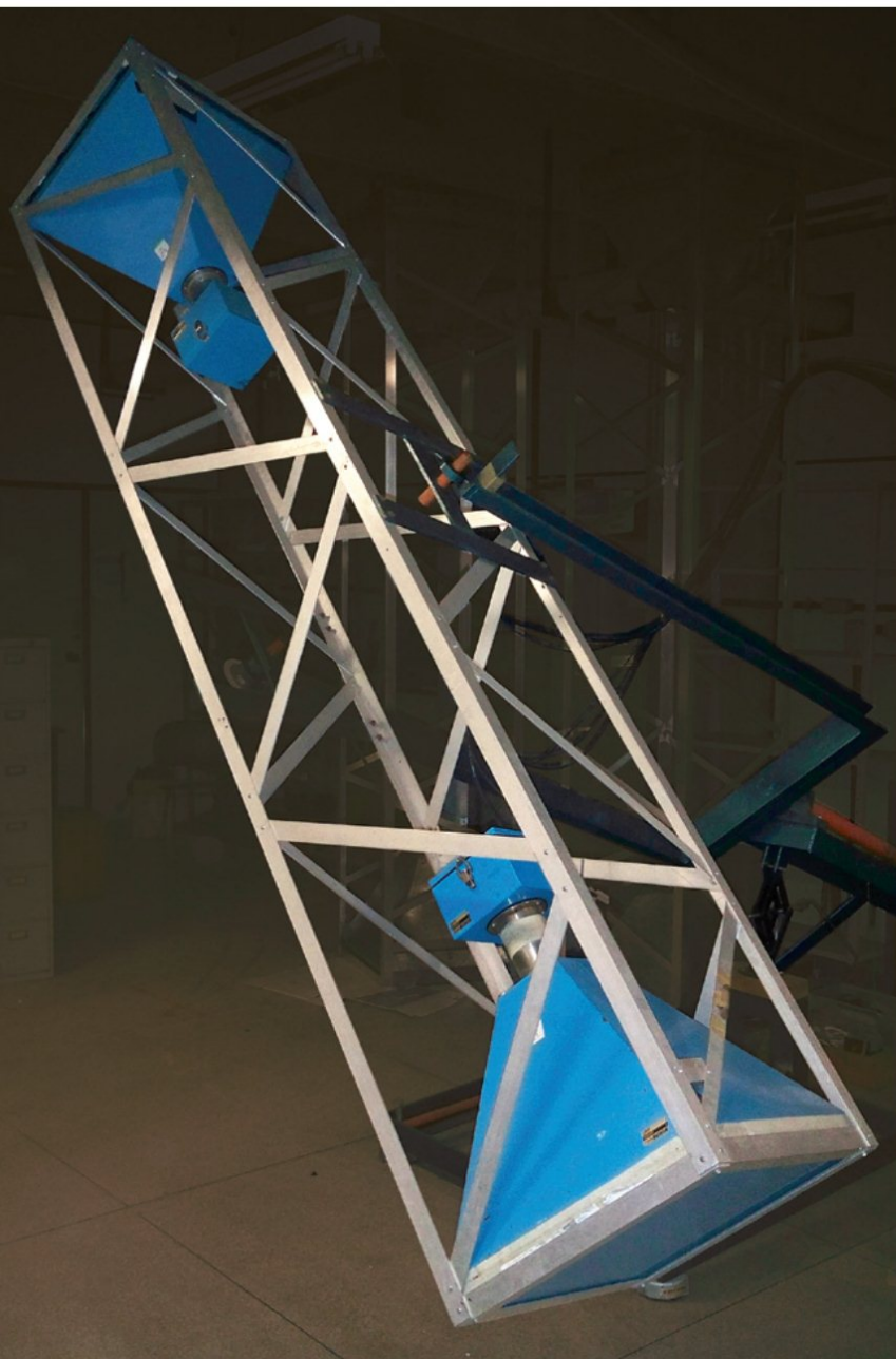
Figura 5. Telescópio Tupi (inclinado em 45 graus). Nos extremos da armação metálica, estão localizados os detectores (cintiladores plásticos)
