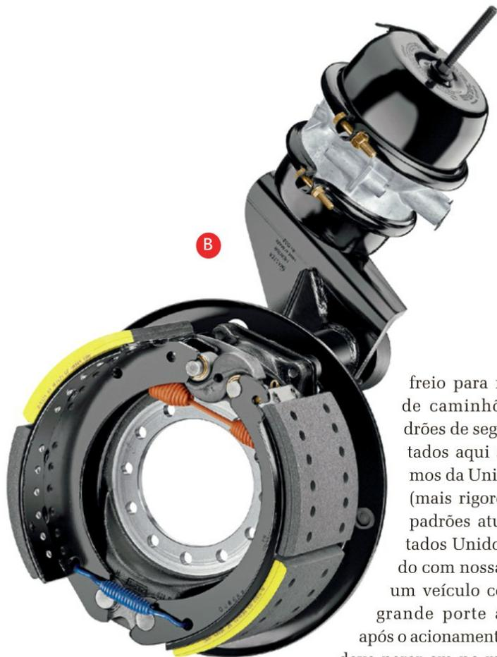
tes. Desenvolveram materiais que propiciam maior área de contato entre a lona e o tambor, e também mais resistentes à temperatura. Além disso, passaram a usar matérias-primas menos abrasivas. Os materiais de atrito são compostos basicamente por três elementos: aglomerantes (geralmente resinas fenólicas), modificadores de atrito (materiais abrasivos e lubrificantes) e fibras (de celulose, vidro, cerâmica, aço, entre várias outras).
