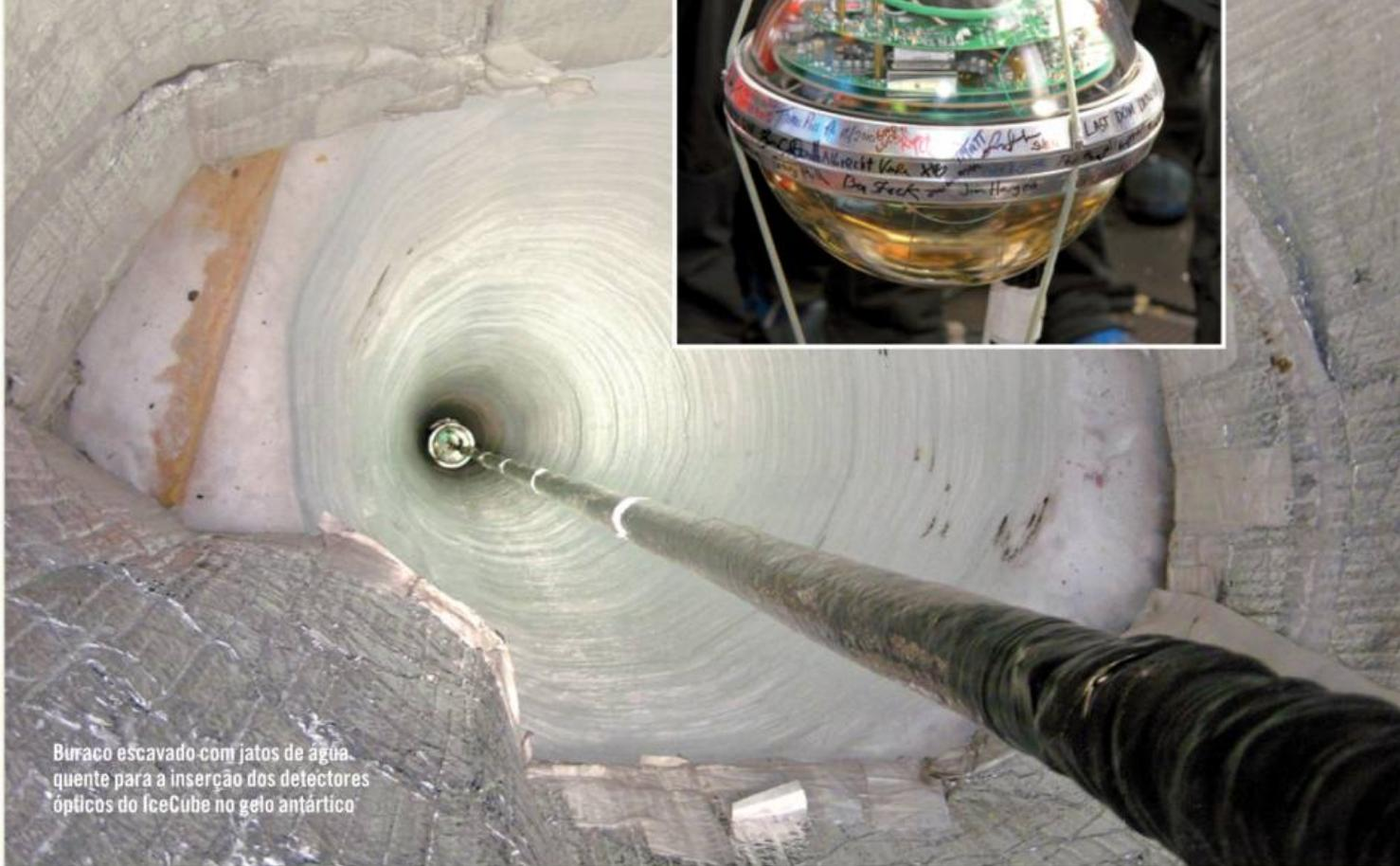
Buraco escavado com jatos de água quente para a inserção dos detectores ópticos do IceCube no gelo antártico
