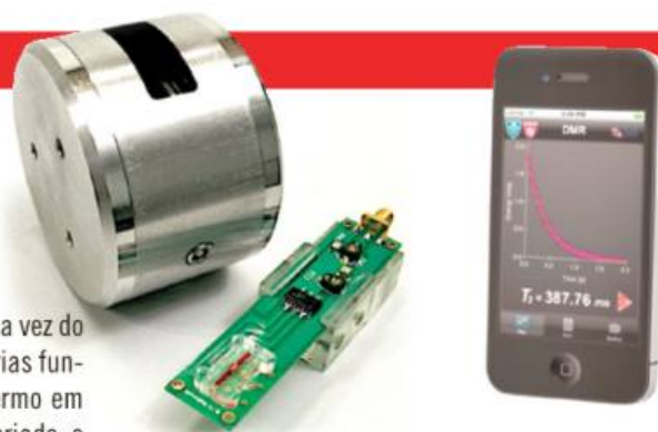
Aparelho portátil de ressonância magnética nuclear, juntamente com celular inteligente, para diagnóstico do câncer
