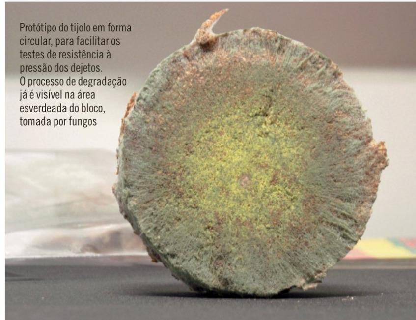
Protótipo do tijolo em forma circular, para facilitar os testes de resistência à pressão dos dejetos. O processo de degradação já é visível na área esverdeada do bloco, tomada por fungos
