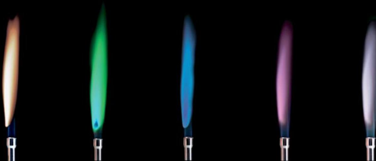
Figura 1. Ensaio de chama para compostos de diferentes elementos
