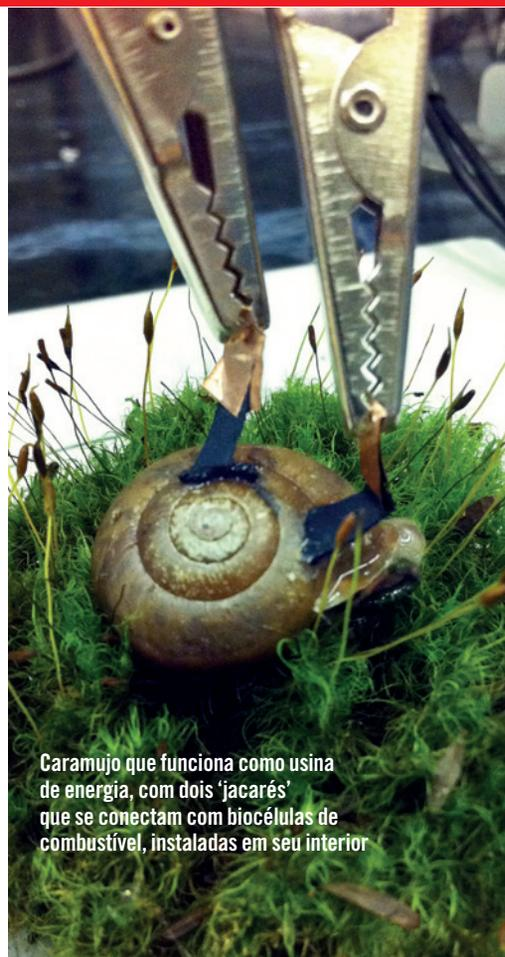
Caramujo que funciona como usina de energia, com dois 'jacarés' que se conectam com biocélulas de combustível, instaladas em seu interior
