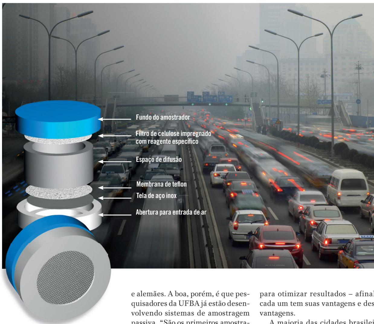
Modelo de amostrador passivo para poluentes atmosféricos
