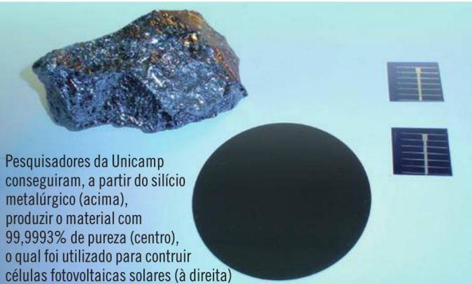
Pesquisadores da Unicamp conseguiram, a partir do silício metalúrgico (acima), produzir o material com 99,9993% de pureza (centro), o qual foi utilizado para contruir células fotovoltaicas solares (à direita)
