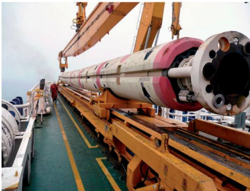
As perfuratrizes do IODP obtêm amostras de sedimentos profundos dos oceanos e das rochas abaixo deles
