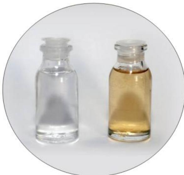
Glicerina comercial (à esquerda), após purificação. Com o desenvolvimento de um novo composto, a glicerina residual (à direita) não precisará passar por um processo de alto custo para ser reaproveitada
