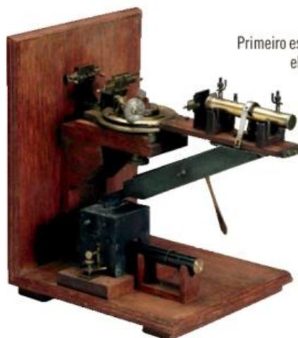
Primeiro espectrômetro de raios X, elaborado por Sir William Lawrence Bragg. Com o equipamento ele foi o primeiro a mostrar, em 1921, que a estrutura molecular poderia ser determinada com a difração de raios X
