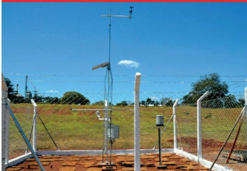
Estação meteorológica em Indiaporã (SP). Tais instalações são fundamentais à agricultura, por medir variáveis como temperatura, umidade do ar, índice de radiação solar e velocidade do vento
