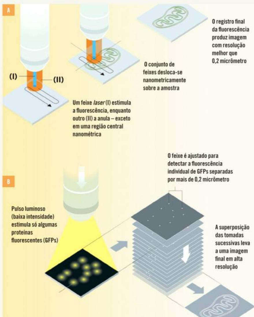
Figura 1. Esquema de funcionamento do microscópio STED (A) e de molécula única (B)
