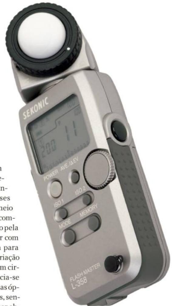
fonte luminosa a certa distância, é cobrir um radiômetro que responde uniformemente a todas as frequências da luz visível com um filtro que simula a sensibilidade espectral do olho. Um aparelho assim construído é chamado fotômetro (figura 2) e é facilmente reconhecível pelo disco branco leitoso que cobre sua superfície sensível e faz o papel de filtro.
