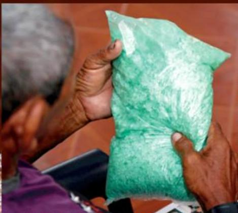
Resultado de uma mistura compacta de copos de café e fibra de babaçu, ou serragem, o ecopiso está sendo feito por pescadores de Colares (PA). No detalhe, após coletarem os copos de café, os moradores lavam os plásticos com água sanitária e, depois, os trituraram manualmente
