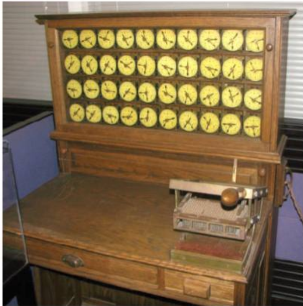
Com um jeito de escrivadinha, este é o primeiro modelo de computador movido a eletricidade.
